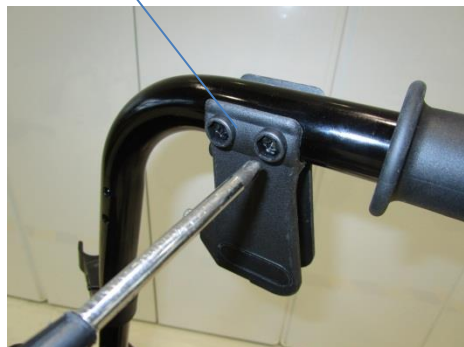
ブレーキ基部固定ボルト
